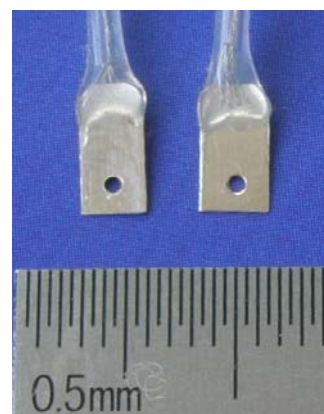
Рис.3. Электроды нейростимулятора НейСи-3М. Материал – Pt 99,99
